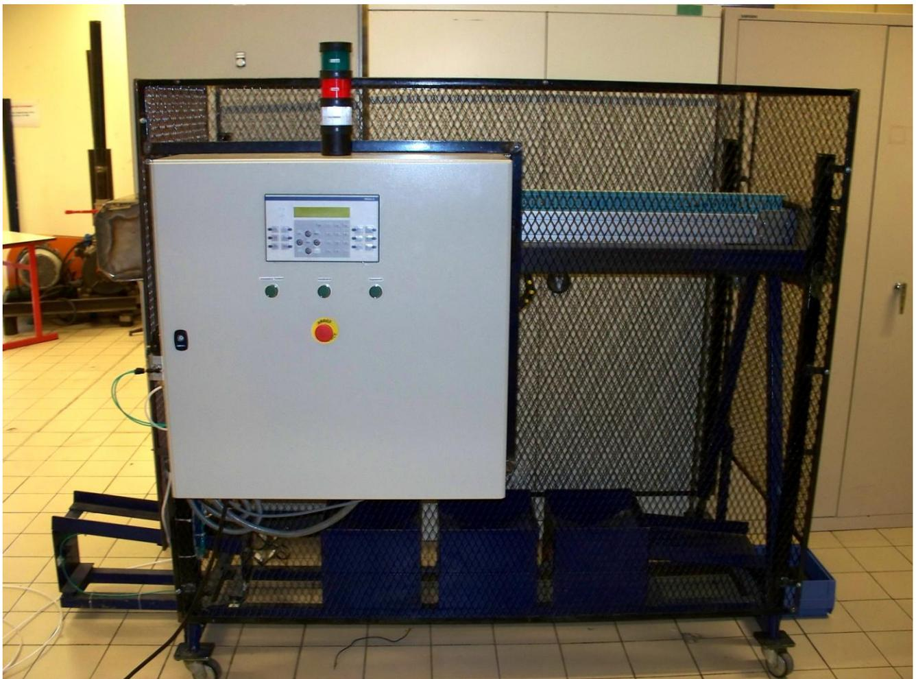
Pour finaliser ce projet, l'équipe pédagogique de Maintenance des Equipements Industriels du lycée a modifié le programme, afin de supprimer les aléas de fonctionnement qui subsistaient, et rendre possible la modification des réglages de position en mode codeur, par l'intermédiaire du terminal de dialogue.
