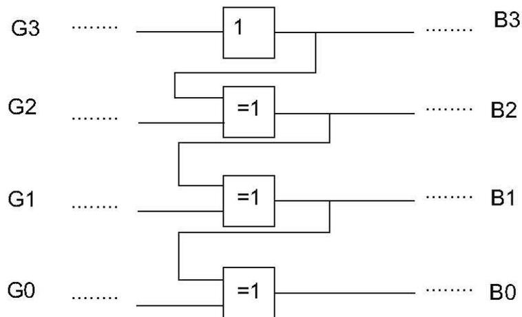
**LES SYSTEMES DE NUMERATION ET CODES****APPLICATIONS****Transcodage binaire pur ==> binaire réfléchi**
