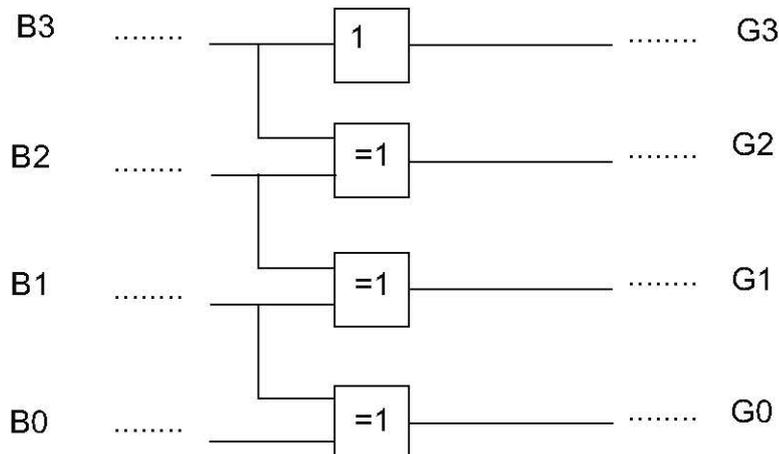
Ce type de transcodage est utilisé pour le décodage des informations fournies par les capteurs rotatifs (codeurs absolus).
