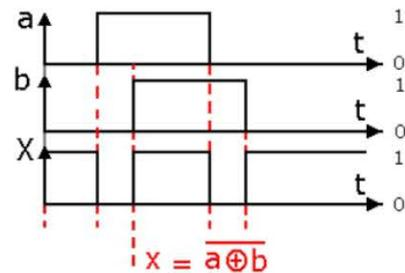
Elle sera utilisé dans les circuits arithmétiques ou en automatisme pour tester l'égalité de deux variables
