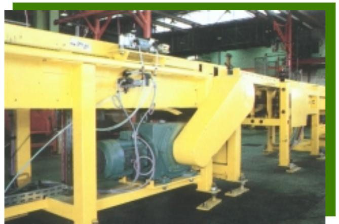
Entrainement d'une chaîne de montage dans l'industrie mécanique (OTHOBLOC OT 24)
