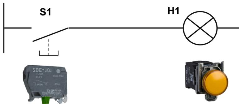
Mesure de la tension aux bornes du bouton poussoir :
